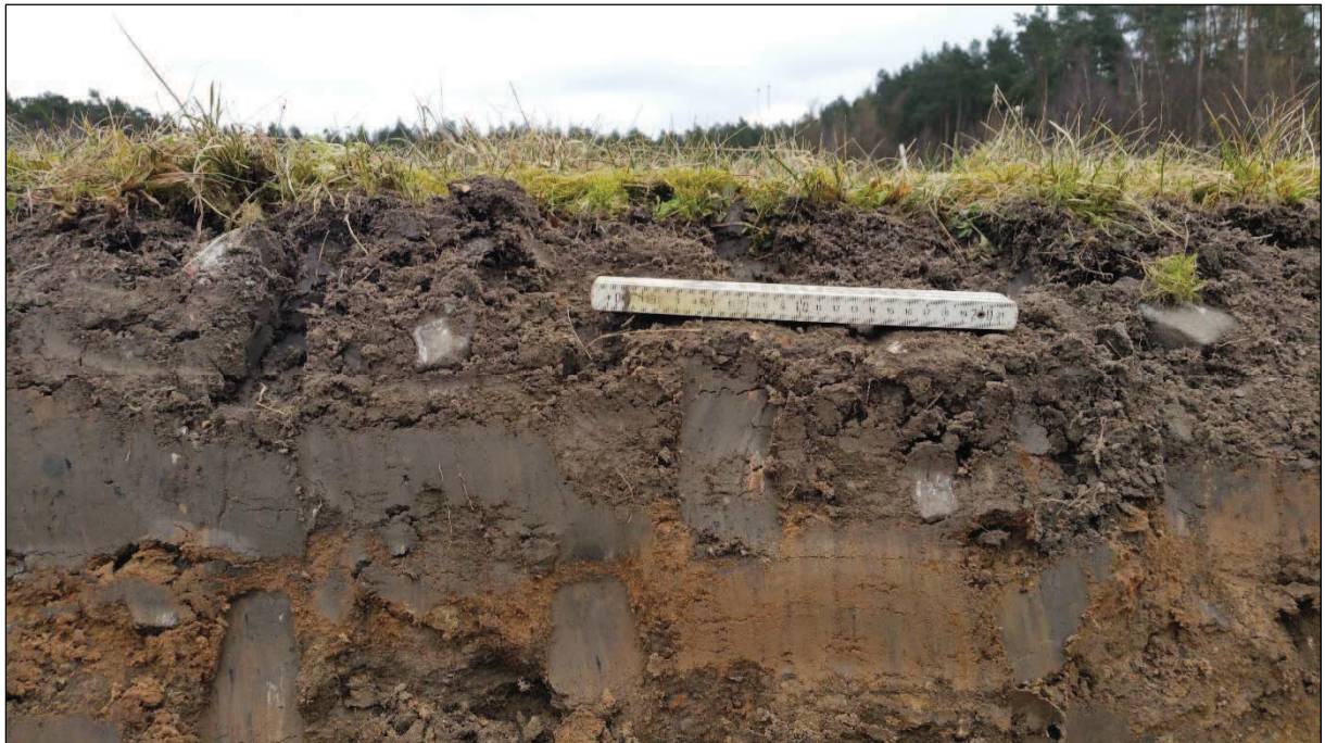
Foto 8: Schurf 7: Oberboden mit Schottern und Grasnarbe; unterhalb wechselnd körnige, braune Sande (Auffüllung), Blickrichtung Süden, Aufnahmedatum 23.03.2018.
